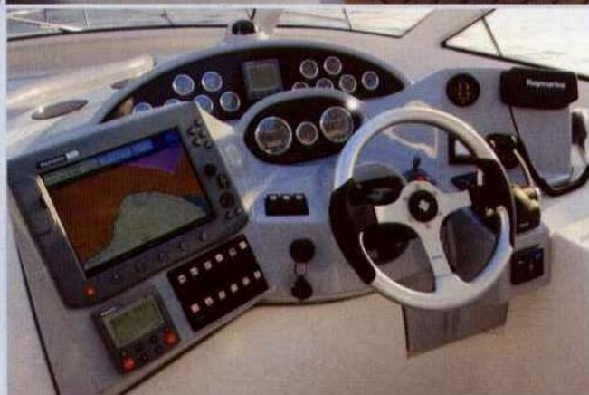
Sopra, l'avvolgente cruscotto. Quadri e strumenti sono rivolti verso il pilota, per facilitarne la lettura, e per renderli tutti a portata di mano sono stati disposti su piani diversi.
