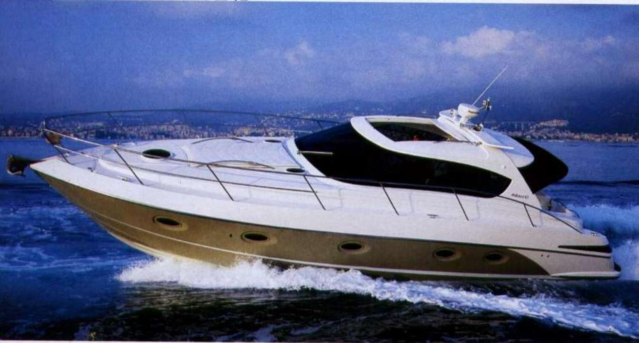
*L'Elan Power E42 mostra in virata tutta la sua agilità e precisione di rotta, frutto di una carena monoedrica profonda per tutta la sua lunghezza. L'elevato angolo di sbandamento è però sinonimo di una minore stabilità all'ancora.*
